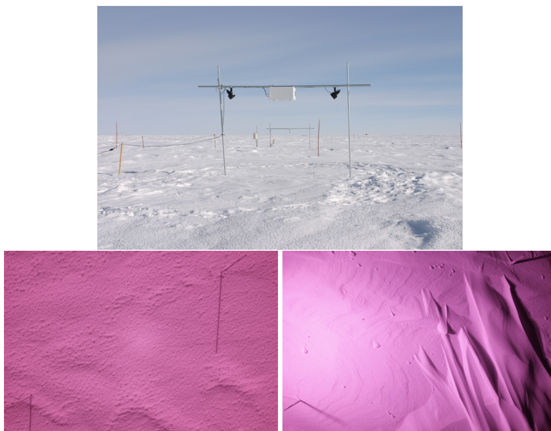
FIGURE 3.16 – Instrument Pauto à Dôme C dans le secteur du Shelter Hélène (en haut). Photos prises en été le 25 janvier 2011 (bas gauche) et en hiver sous éclairage artificiel le 24 mai 2011 (bas droite). A noter l'accumulation entre les deux dates visible sur les piquets.
